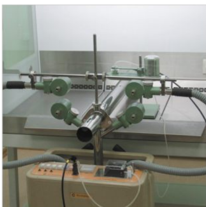
KI-DISKUS-TEST Damit wir das Rückhaltevermögen von Aerosolen in der Arbeitsöffnung überprüft. Er ist ein Alternativverfahren zur mikrobiologischen Prüfung.
