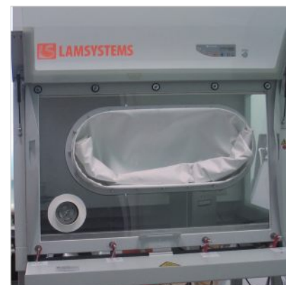
DEKONTAMINATION MIT FORMALDEHYD UND H 2 O 2 (BEGASUNG) Die Sicherheitswerkbank ist für alle Begasungsverfahren geeignet. In der Betriebs- und Wartungsanweisung ist ein vereinfachtes Desinfektionsverfahren mit Formaldehyddämpfen beschrieben.
