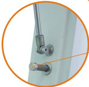
Hydraulischer Dämpfer für die Frontscheibe
